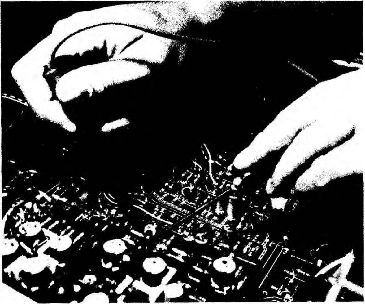
Fig. 10 Esecuzione pratica della verifica di un transistore inserito in un circuito
